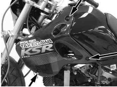
フロントカウル固定ボルト4本を外し、フロントカウルのヘッドライトユニットの6Pカブラ(白色)の接続を外して、フロントカウルを車両より取り外して下さい。
