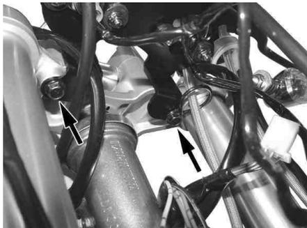
メーターステーに純正のイグニッションスイッチを裏側からはめ込み、イグニッションスイッチカバーにて固定して下さい。
