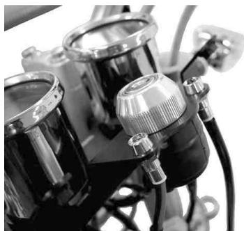
イグニッションスイッチのコードを車体左側から取り回し、車体側の白色2Pカプラも車体左側に移動させて接続して下さい。
