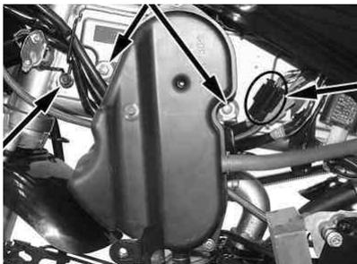
スピードメーターケーブルを取り外し、トップブリッジ裏面のメーターステー固定ボルト2本を外し、純正スピードメーター及びメーターステーを取り外して下さい。
