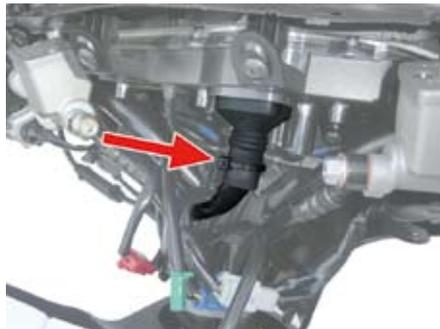
5. 変換ハーネス（灰色コネクタ側）を、車両のメーターハーネスに接続します。なお、スーパーマルチ LCD メーターに車両のメーターハーネスを接続すると、キー OFF であっても一度メーターに電源が入り、タコメーターが振り切るオープニング動作と、LCD ディスプレイに弊社ロゴや r0/p といった文字及び十字上のパターン表示を行った後、自動で電源 OFF になりますが、セルフチェック動作ですので正常です。また、表示される文字は弊社管理用の為、ご購入頂く時期などにより数値が異なる場合があります。
