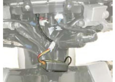
7. 外付けアダプタの 3P コネクタが付いたコードを、車両のメインハーネスと共に車両後方のバッテリー部まで這わせて、バッテリー後方よりケーブルが入る穴を利用して、トランクスペース内に 3P コネクタを通します。
