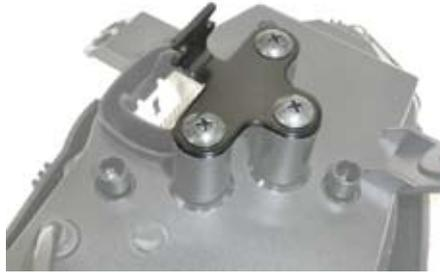
4. 純正メーターを取り外した逆手順で、ハンドルアッパーカバーにスーパーマルチ LCD メーターを元通り組み付け、スーパーマルチ LCD メーター裏面のコネクタに、キット付属の変換ハーネス（白色コネクタ側）を接続します。コネクタ接続後、変換ハーネスを必ず純正ケーブルステーに結束バンド 200mm で固定して下さい。
