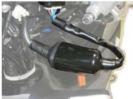
6. スーパーマルチ LCD メーター裏面から出ている白色 4 ピンコネクタに、キット付属の外付けアダプタを接続します。ステアリングを左右に切ってもハーネス類に無理が掛からない位置に、キット付属の結束バンド 290mm を用いて外付けアダプタ本体部分をメインハーネス等に固定して下さい。
