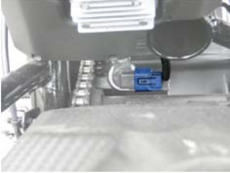
5. 青色 3P コネクタを外した純正スピードセンサのコネクタ部に、キット付属のキャップφ 15.5 を被せます。
