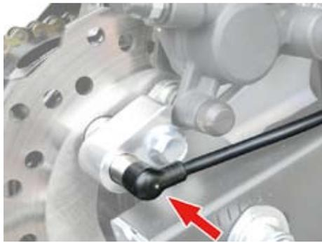
点灯も消灯もしない場合は、スピードメータードライブユニット Assy. との接続、及びディスクボルトと金属反応式速度センサーの隙間寸法を確認して下さい。
