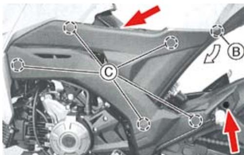
3. 純正リアキャリアサポートの取り付けスクリュー2本を緩め、後ろ側スクリューは取り外します。
