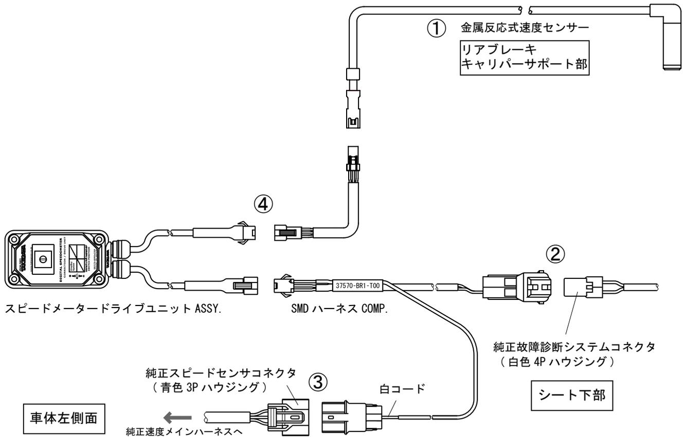
▲ 注意：各ハーネス類を車両に取り付け接続する際、スイングアームが可動したりシートを脱着してもハーネス類を挟み込んだりしないように取り付けて下さい。
