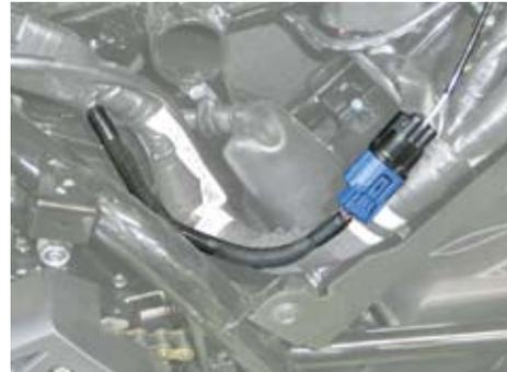
④ 配線図の様にスピードメータードライブユニット ASSY. から出ている 3P コネクタを、それぞれ SMD ハーネス COMP. とサブコードと金属反応式速度センサーに接続します。
