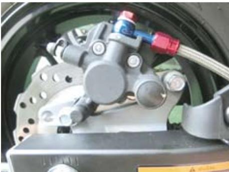
▲ 注意：スピードセンサーホルダーを取り付ける際、矢印の部分（スピードセンサーホルダーとキャリパホルダ）に隙間が出来ないようにして下さい。
