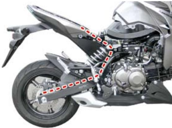
② シート下 進行方向左側部分にある、純正故障診断システムコネクタ (図中矢印部分 白色 4P ハウジング) の保護キャップを外し、SMD ハーネス COMP. の 4P ハウジングを接続します。
