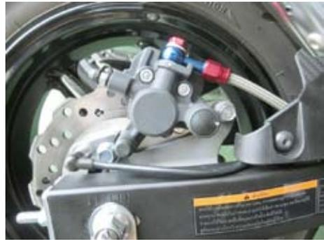
3. 写真を参考にしてブレーキディスク取り付けボルトと、金属反応式速度センサーの隙間を 2mm ± 1mm に調整します。
