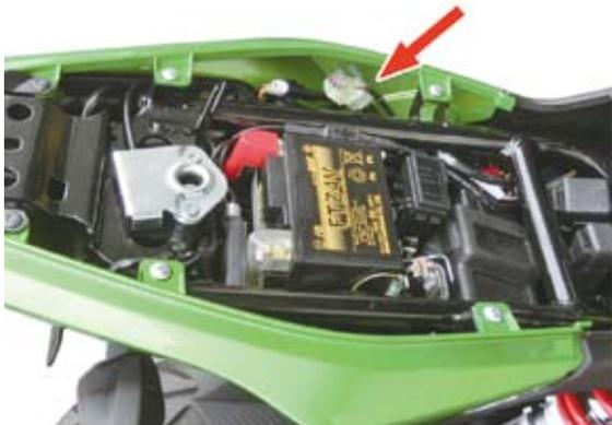
③ SMD ハーネス COMP. の 3P コネクタ付き白コードを、車体左側面まで這わせ、純正スピードセンサに接続されていた青色 3P コネクタと接続します。
