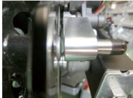
4. ソケットセットスクリュー 4x5 にネジロック剤（中強度）を塗布し規定トルクで締め付けます。
