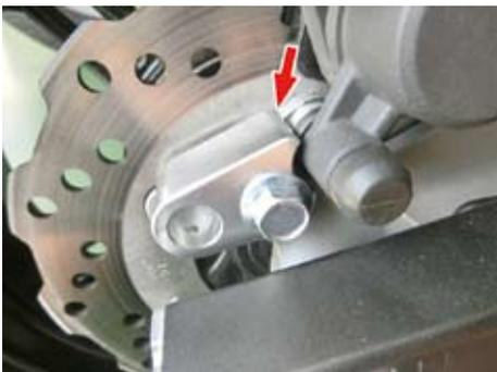
2. 金属反応式速度センサーをスピードセンサーホルダーに取り付けます。
