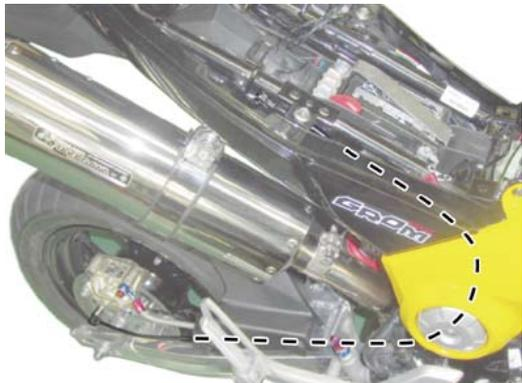
○④ SMD サブケーブルの細い径のメスギボシ端子側を車体左側面まで這わせエンジン上部のコネクタカバー内にある白 / 赤コードのオスギボシ端子に接続します。
