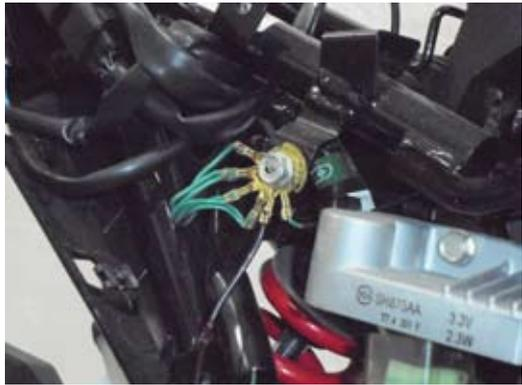
○①スピードメータードライブユニット ASSY. と各ケーブルの同じ色同士のギボシ端子を接続します。
