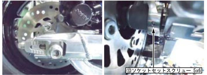
速度センサーをスピードセンサーホルダーに取り付けます。
