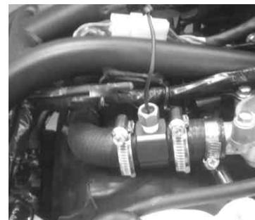
カワサキ純正サービスマニュアルを参照してフューエルタンクを取り付け、ラジエーター水を注入します。メインキーをONにし、サーモメーターが正常に表示するか確認します。同時にメーター内の警告等、車体側に異常がないか確認して下さい。エンジンを始動し、アイドリングの状態にてラジエーター水の漏れが無いかなど各部の点検を行って下さい。
