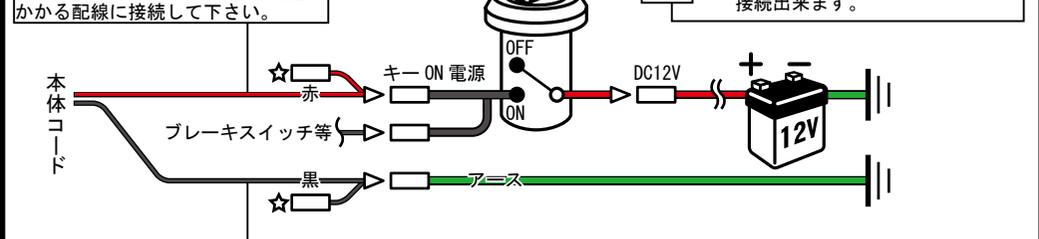
赤コードをキー ON で DC12V の電圧がかかる配線に接続して下さい。
