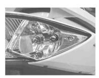
Jan./23/ 10 -26 . 純正のテールランプバルブを取り外し、キット付属の L E D テール | バルブを取り付けます。 |
