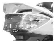
3. テールレンズの後部上2箇所に爪がありますので、ハウジングを 破損しない様に注意しながら、純正のテールレンズを車両から取り 外します。
