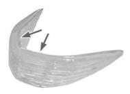
ていますので、タッピングスクリュー2本を取り外して、カバーを 取り外します。
