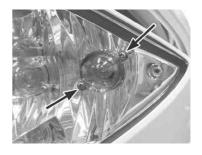
5. 純正のウインカーバルブを取り外し、キット付属のメッキウイン カーバルブを取り付けます。
