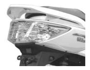
⚠注意:テールレンズの両サイドの先端部分が、ランプハウジングに 正しく嵌り込む様に取り付けて下さい。 正しくはまり込まないままで取り付けすると、水や埃が内部
