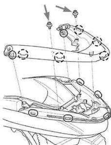
グラブレールカバーを外側に押し、溝部をグラブレール突起部から外します。
