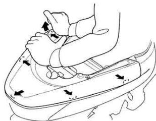
グラブレールカバーの前側を引き上げ外してから、後側を引き上げてグラブレールを取り外します。
