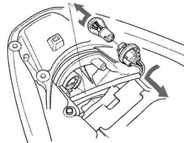
8. 純正テールランプの裏面上部に付いているL字型のVENTチューブ(ラバーホース)を、LEDテールランプに付け替えます。純正ソケットをLEDテールランプに取り付けます。
