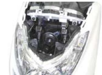
2. リアウインカーを固定しているスクリュー2本を取り外して車両よりウインカーを取り外し、ウインカーバルブを交換します。
