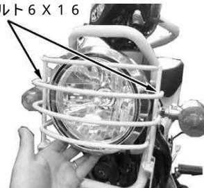
取り外したリフレクターを組み付けます。
