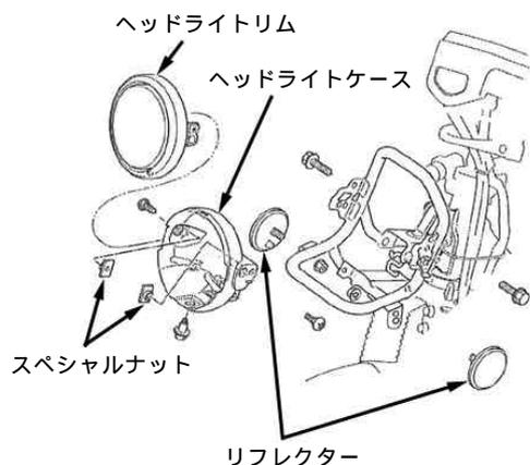
ヘッドライトリムとヘッドライトケースを取り外した際、スペシャルナットを接着剤等で固定して下さい。
