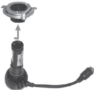
4. 車両のヘッドライトにソケット金具部分のみを取り付けます。
