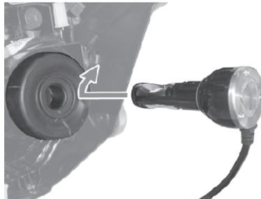
7. LEDヘッドライトのヒートシンクのスリット部分が、ヘッドライトハウジングやラバーで塞がれていないか確認します。
