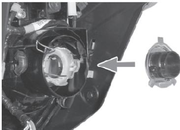
5. ヘッドライトのバルブ部分にラバーカバーがある場合は、この段階でソケット部分にラバーを取り付けます。
