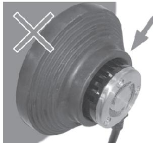
8. LEDヘッドライトとLEDコントローラーの丸型コネクタを接続し、ナットを回して固定します。
