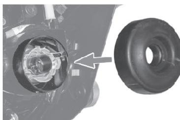
6. LEDヘッドライトを、ソケット金具部分に挿入し、時計方向に少し回して固定します。
