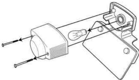
3. ブレイズLEDテールCOMP.を取り付ける前に、パッキンが損傷等していないか確認して下さい。
