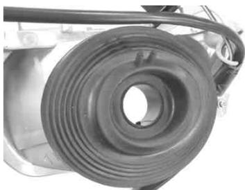
10. LEDヘッドライトを、ソケット金具部分に挿入し、時計方向に少し回して固定します。
