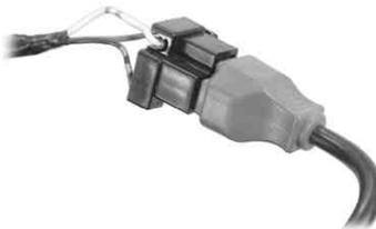
14. ヘッドライトユニットASSY.のポジションランプを点灯させる場合は、キット付属のインジケータークード(レッド)を車体のオレンジ色配線にエレクトロタップで接続します。
