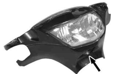
ポイント：本キットのヘッドライトとLEDヘッドライトバルブの組み合わせでは、構造上純正ヘッドライトよりも光軸が下向きになる傾向がありますので、かなり上方向に向ける事が必要となる場合があります。
