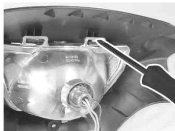
5. 純正ヘッドライトユニットの中央上部に貼り付けられているラバーを剥がし、キット付属のヘッドライトユニットASSY. に貼り替えます。
