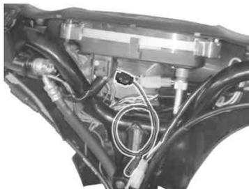
15. ヘッドライトユニットASSY.から出ている3Pカプラを、車体のヘッドライトカブラに接続します。また、ポジションランプを点灯させる場合は、インジケータークード(レッド)のメスギボシ端子と、ヘッドライトユニットASSY.から出ているオスギボシ端子も接続します。
