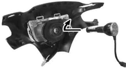
11. LEDヘッドライトとLEDコントローラーの丸型コネクタを接続し、ナットを回して固定します。
