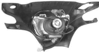
13. LEDコントローラーの青色3Pコネクタを、ヘッドライトユニットASSY.のヘッドライトバルブコネクタに接続します。
