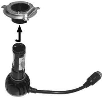
8. ヘッドライトユニットASSY.にLEDヘッドライトバルブの金具だけを取り付けます。
