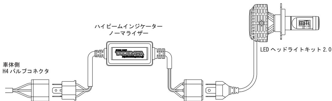
2. 取り付けが完了したらヘッドライトを点灯し、ハイビームにした際にメーター内のハイビームインジケータが正常に作動するかどうか、また ロービーム / ハイビームが正常に切り替え出来るかといった点灯チェックを行って下さい。
