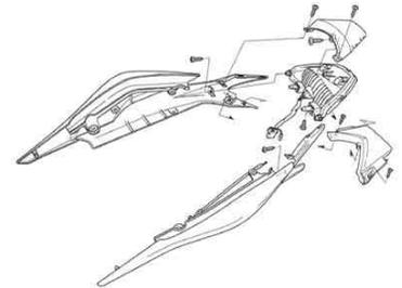
6. 取り外した純正テールランプから、ラバーチューブを2個取り外し、LEDテールランプに取り付けます。
