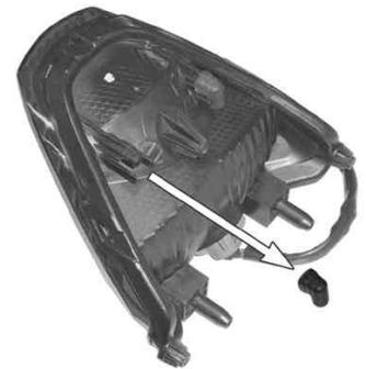
7. テールランプを取り外した逆の手順で、LEDテールランプを取り付けます。
