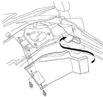
4. シートロックケーブル・ブレーキ/テールライトカプラ テールライトコネクタ・ボルト類を取り外し、リアカウルを車体から取り外します。
