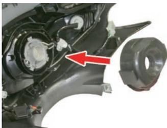
6. LEDヘッドライトを、H4ソケット部分に挿入し、押し込みながら時計方向に回して固定します。車種によっては、純正のラバーカバーと干渉する為、押し込むように回さなければ取り付け出来ない場合も有ります。また、H4ソケットに対してLEDヘッドライトが天地逆でも取り付け出来ますが、コントローラー部から出ているコードが地面を向くように取り付けて下さい。
