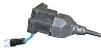
▲注意：車両側コネクタの形状や状態によっては、黒色3Pコネクタが完全に奥までは挿さらず、コネクタ端子根元部分が露出する場合があります。端子の勤合が緩い車両があります。必要に応じて、絶縁ビニールテープでコネクタ部を巻くなどの対策を講じて下さい。
