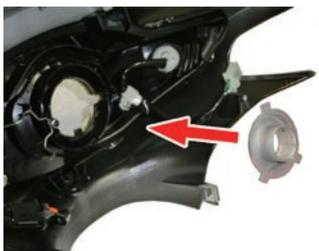
5. ヘッドライトのバルブ部分にラバーカバーが有る場合は、この段階でソケット部分にラバーカバーを取り付けます。LEDヘッドライトのH4ソケット部と、純正ハロゲンバルブでは多少寸法や形状が異なりますので、車両によっては、ラバーカバーを一部切除する必要があります。
