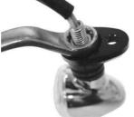
車体側に純正ラバーがしっかりと取り付けられているか確認します。 ウインカーマウントと純正のウインカーベースを取り付け、付属のソ ケットキャップスクリューM6X15にて取り付けます。
