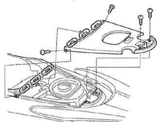
△注意：カバー類の脱着時、爪部分や溝部分を破損しない様に、注意深く作業を行って下さい。
