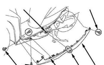
7. ボディーカバーを取り外します。ボディーカバー取り外しの際、リアコンビネーションライト9Pカプラの接続の取り外し忘れがない様、注意して下さい。
