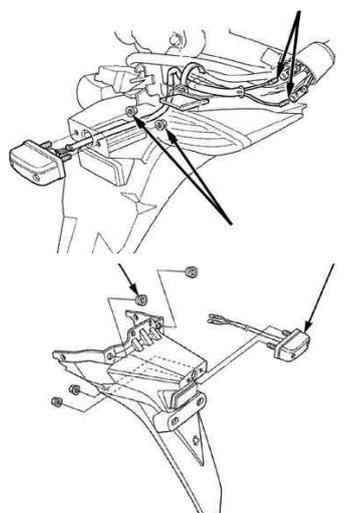
10. ボルト、ナットを外し、ライセンスプレートを外します。
