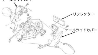
テールランプの組み付けが完了すれば点灯状態を確認し、問題無けれ ば取り外した部品を組み付けます。
