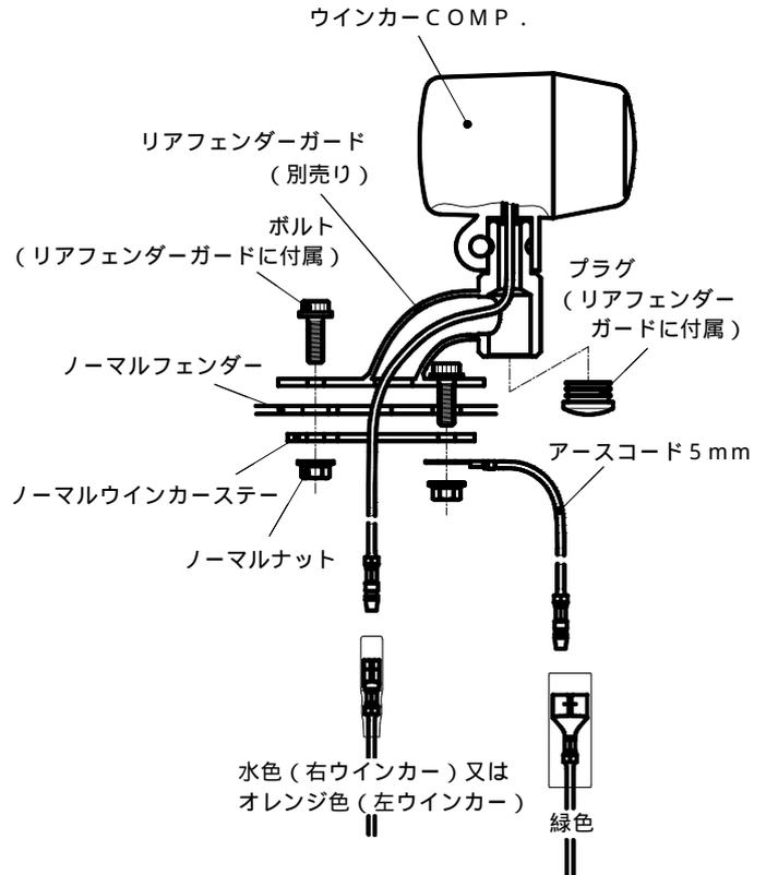
ウインカーの角度を調整し、仮止めしていたウインカーCOMP.の6角ナット6mmを締め付ける。
