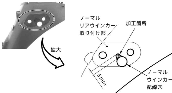
ウインカーCOMP.の配線をリアフェンダーガードに通した後、6角ボルト、ワッシャ、スプリングワッシャ、6角ナット6mmにて仮止めする。プラグをリアフェンダーガードに取り付ける。
