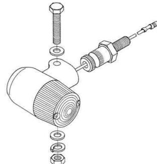
下図を参考にし、ヘッドライトステーにウインカーCOMP./ウインカーステー、カラー、アースコード8mm、スプリングワッシャ、6角ナット8mmをウインカーの角度を調整し取り付け。
