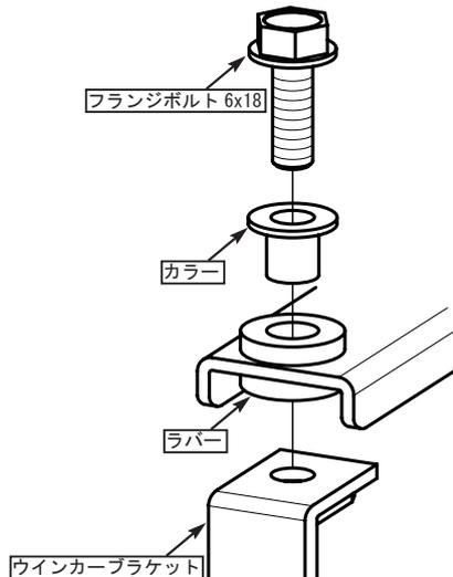
ステーの上のみラバーがあるタイプはラバーとカラーを外して⑦フランジボルト 6x10 にてウインカーブラケットを取り付けます。
