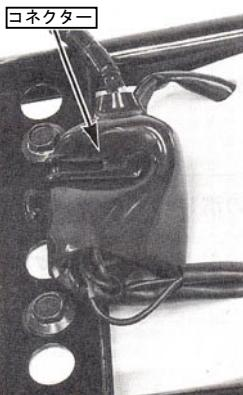
2. ウインカー取り付け部の 6mm ボルトを緩めて、左右のリアウインカーをそれぞれ取り外します。
