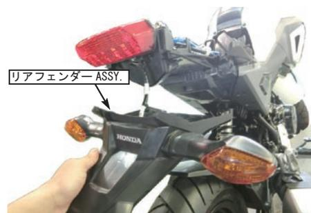
4. インナーフェンダーを固定しているスクリュー5本を外して、インナーフェンダーを取り外します。
