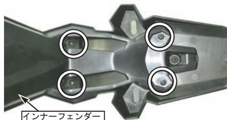
5. リフレクター下部のフランジボルトとワイヤバンドを外し、フェンダーステーを取り外します。
