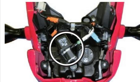
7. 取り外したウインカーステー（またはカウル）、ヘッドライトASSY.等を、ホンダ純正サービスマニュアルを参照して取り付けます。
