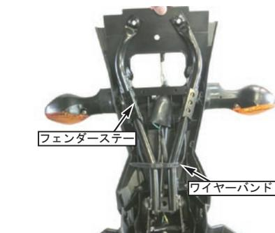
6. 左右ウインカーの配線の接続を外し、ナットを取り外して左右のウインカーとウインカープレートを取り外します。
