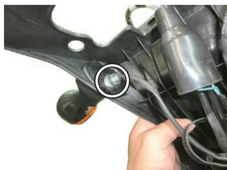
7. LED ウィンカー COMP. (リア用) の配線に、プレーンワッシャ8mm (外径16mm) とスペーサー、リアウインカーマウントを通しリアフェンダーに形を合わせて取り付け、裏側からプレーンワッシャ8mm (外径22mm) と、六角ナット8mm でウィンカーを固定します。
