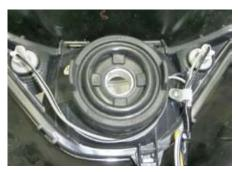
10. LEDへッドライトをH4 ソケット部分に挿入し、押し込みながら時計方向 に回して固定します。
