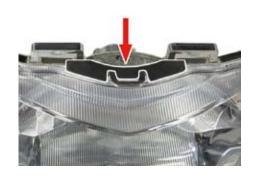
6. 本キット付属のヘッドライトユニットASSY. に装着されている、コネクタ とラバーカバーを取り外し、ハロゲンバルブを取り外します。
