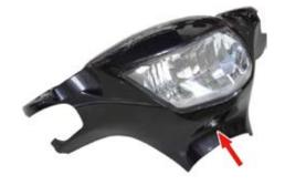
4. 純正ヘッドライトユニット上部のツメを、マイナスドライバー等で外して、ハンドルバーフロントカバーより純正ヘッドライトを取り外します。
