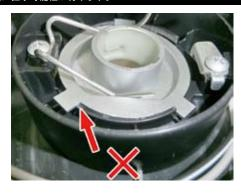
9. ヘッドライトユニットASSY. から取り外したラバーカバーを再度組み付けます。
