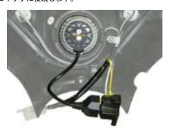
12. 車両のヘッドライトバルブコネクタに、キット付属のヘッドライトサブ ハーネスCOMP. を接続します。
