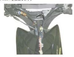
13. ヘッドライトユニットASSY. のポジションランプを点灯させる場合は、インジケーターコード(レッド)を車体のオレンジ色配線にエレクトロタップで接続し、インジケーターコードのメスギボシ端子と、ヘッドライトサブハーネスCOMP. の赤色コード・オスギボシ端子を接続します。
