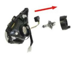
7. LEDへッドライトのH4ソケット部分を、ヒートシンク側に押し込みながら、反時計方向に少し回して引き抜きます。
