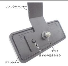
・ナンバープレートが接触する箇所にラバープレート 20x20x1 をリフレク ターステーに貼り付ける。
