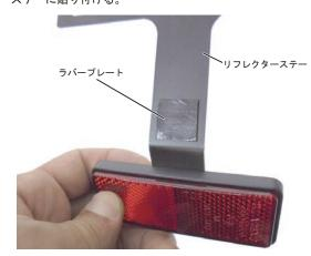
・リフレクターステーとナンバープレートを共締めにてブラケット ASSY. に取り付ける。
