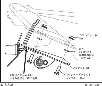
・弊社製グラブバーとの併用の場合、この製品に付属のカラー 8.5x14x2.5 は使用せず、下図を参考に取り付ける
