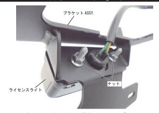
・ノーマルのウインカーを取り付ける場合、ノーマルのプレート、ワッシャ、 ナットを使用して取り付ける。
