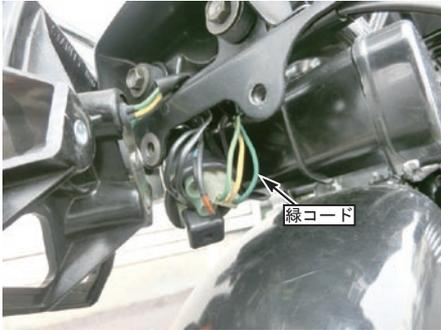
7. ウインカー及びテールランプの配線を束ね、コネクタカバーを被せ、カバー中央部をクランプにて固定します。
