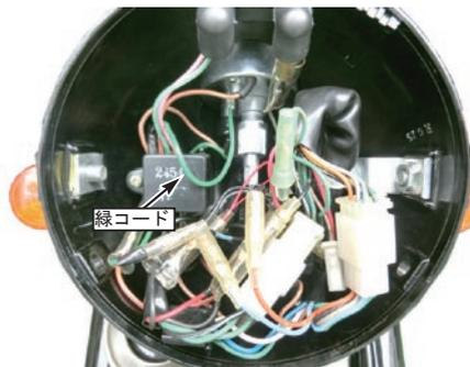
8. ヘッドライトユニットを取り付け、5mm スクリューを締め付けます。
