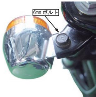
4. LED ウインカー COMP. のコードをウインカーブラケット、プレーンワッシャ 8mm、6 角ナットの順に通してウインカー ASSY. を仮止めします。
