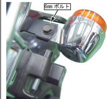
3. フロントと同様に LED ウインカー COMP. コードをウインカーブラケット、プレーンワッシャ 8mm、6 角ナットの順に通してウインカー ASSY. を仮止めします。
