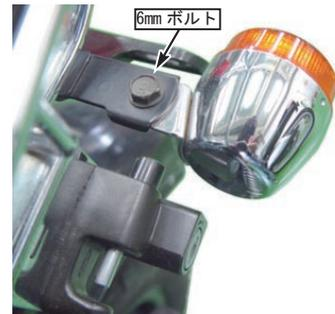
3. ウインカーブラケットをノーマルウインカーと同じ位置にフランジボルト 6x10 にて取り付け、規定トルクで締め付けます。
