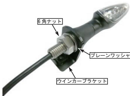
5. ウインカーブラケットをノーマルウインカーと同じ位置にフランジボルト 6x10 にて取り付け、フランジボルトを規定トルクで締め付けます。
