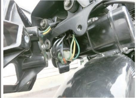
2. ウインカー取り付け部の 6mm ボルトを緩めて、左右のリアウインカーをそれぞれ取り外します。
