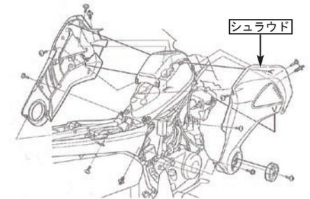
シートを外し、ボディカバーを取り外します。
