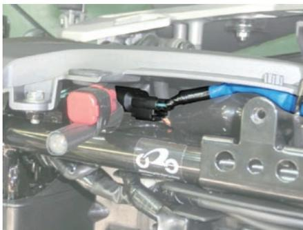
3. 純正ブレーキ/テールライトユニットを固定している、ナット・ワッシャ 各2個を取り外し、車両から純正ブレーキ/テールライトユニットを取り外します。
