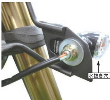
4. ウインカー本体が地面に対して水平になる様にウインカーの角度を調整し、六角ナットを締め付けます。
