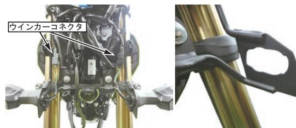
3. ストリームラインウインカーに備え付けの六角ナットを取り外し、ストリームラインウインカー、ウインカーマウント、ウインカーステー、ブレンワッシャ 8mm、取り外した六角ナットの順で車体に取り付けます。
