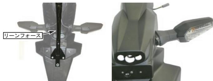
4. ストリームラインウインカーに備え付けの六角ナットを取り外し、ストリームラインウインカー、ウインカーマウント、ウインカーステー、ブレンワッシャ 8mm、取り外した六角ナットの順で車体に取り付けます。
