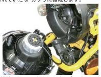
12. 接続した 3P コネクタ及びカプラが、ヘッドライトケース中央下部の窪み部分に嵌まり込ませて、ヘッドライトをヘッドライトケースに再度取り付けし、ヘッドライトマウントスクリュで固定します。
