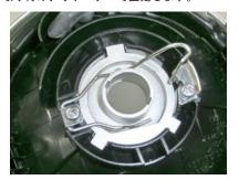
9. 裏面突起の除去加工をしたダストカバーの"TOP" マークがヘッドライトの上側を向くようにして、 ヘッドライトの一番奥まではめ込みます。
