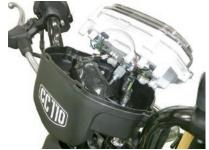
3. コンビネーションメーターケース内にある ブーツ内の、L. ハンドルスイッチ 4P カプラと、 フロントブレーキライトスイッチのギボシ端子 (黒色コード) に、キット付属のヘッドライト サブハーネス COMP. を接続します。
