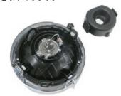
4. 取り外した純正ヘッドライトのヘッドライト バルブを押さえているリテーナー先端を外し、 ヘッドライトバルブを取り外します。
