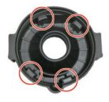
図を参考に純正ヘッドライトのリテーナーの 〇印部分あたりをラジオペンチなどで掴み、 外側へ曲げます。
