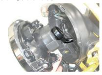
3. 取り外した純正ヘッドライトからダスト カバーを取り外します。
