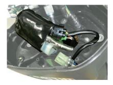
12V 白熱球用の交流 (半波整流)が 出ていますが、本キット取り付け時は、 何も接続しません。 33130-KZV-T00 黒色コード 黒色コード エートのエートのエートのエートのエートのアライトサブハーネス COMP.
