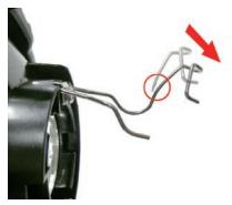
7. LED ヘッドライトバルブの H4 ソケット部分を、 ヒートシンク側に少し押し込みながら、 反時計方向に少し回して引き抜きます。
