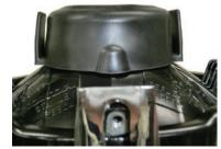
10. LED ヘッドライトバルブを、H4 ソケット部分 に挿入し、押し込みながら時計方向に回して 固定します。
