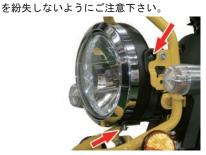
2. 純正ヘッドライトバルブに接続されている 3P カプラを取り外し、車両から純正ヘッドライトを取り外します。
