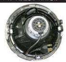
11. LED ヘッドライトバルブから出ている黒色 3P コネクタを、純正ヘッドライトバルブに接続 されていた 3P カプラに接続します。
