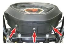
コンビネーションメーターケース裏面の スクリュ2本を取り外し、コンビネーション メーターを浮かせます。
