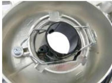
⚠ 注意：金具装着時、下側の爪 2箇所がヘッドライトハウジングに正しく嵌まり込んでいる事をご確認下さい。
