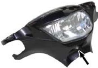
4. 純正ヘッドライトユニット上部のツメを、マイナスドライバー等で外して、ハンドルバーフロントカバーより純正ヘッドライトを取り外します。
