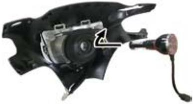
11. LED ヘッドライトバルブと LED ヘッドライトコントローラーの丸型コネクタを接続し、ナットを回して固定します。
