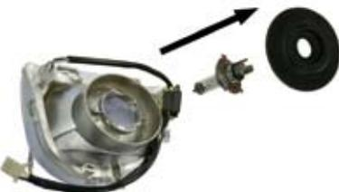
7. LED ヘッドライトバルブのソケット金具部分を、反時計方向に少し回して引き抜きます。
