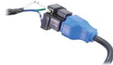
14. ヘッドライトユニット ASSY. のポジションランプを点灯させる場合は、キット付属のインジケータークード（レッド）を車体のオレンジ色配線にエレクトロタップで接続します。
