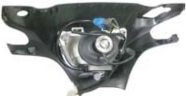
13. LED ヘッドライトコントローラーの青色 3P コネクタを、ヘッドライトユニット ASSY. ヘッドライトバルブコネクタに接続します。
