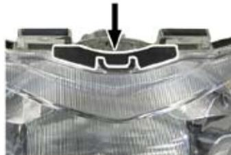
6. 本キット付属のヘッドライトユニット ASSY. に装着されている、コネクタとラバーカバーを取り外し、HS1 ハロゲンバルブを取り外します。
