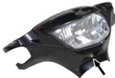
ポイント：本キットのヘッドライトと LED ヘッドライトバルブの組み合わせでは、構造上純正ヘッドライトよりも光軸が下向きになる傾向がありますので、かなり上方向に向ける事が必要となる場合があります。
