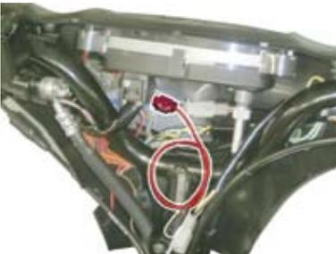
15. ヘッドライトユニット ASSY. から出ている 3P カブラを、車体のヘッドライトカブラに接続します。
