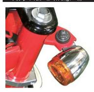
6. ミニブレイズウインカーのギボシ端子を、キット付属のウインカーサブコードに接続します。
