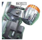
3. フロント同様に、純正ウインカーを取り外した逆手順で、純正ボルトを 再使用しキット付属のミニブレイズウインカーを取り付けます。
