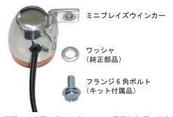
4. 純正ウインカー同様に、車両のウインカーステー裏面からボルトを ステーに通し、純正ナットで固定します。
