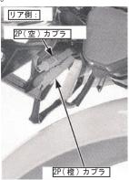
2. 純正ウインカー取り付け部のナットを取り外し、純正ウインカーからウインカマウントボルトとワッシャを取り外します。
