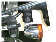
5. ミニブレイズウインカーのギボシ端子を、キット付属のウインカーサブコードに接続します。
