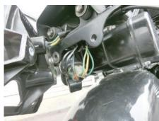
ウインカー取り付け部の 6mm ボルトを取り外し、左右のリアウインカーをそれぞれ取り外します。
