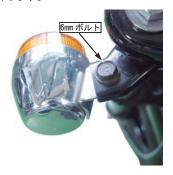
4. 純正ウインカーを取り外した逆手順で、純正ボルトを再使用しキット 付属のミニブレイズウインカーを取り付けます。
