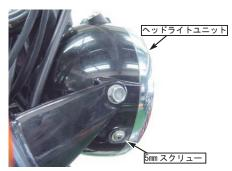
2. ヘッドライトケース内の空色及び橙色コードのギボシを外し、ケース よりコードを引き出します。
