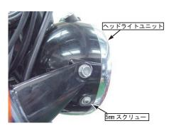
2. ヘッドライトケース内の空色及び橙色コードの 2P カプラを外し、 ケースよりコードを引き出します。
