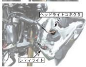
2. ウインカーコネクタを外し、左右のフロントウインカーをそれぞれ取り 外します。
