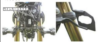
3. ストリームライン LED ウインカーのコードに、ウインカーマウント、 車体側ウインカーステー部、プレーンワッシャ 8mm (特寸)、6 角ナット の順で取り付けます。
