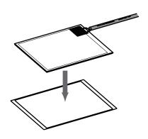
2. レジスターを貼り付けた両面テープの反対側の剥離紙を剥がし、車両のフューエルタンクに貼り付けます。
