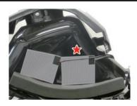
3. キット付属のスポンジ両面テープ 45x60 をハサミ等で幅 5mm 程度の 短冊状に切断して片面のみ剥離紙を剥がし、適宜フューエルタンクに レジスターの配線を固定します。
