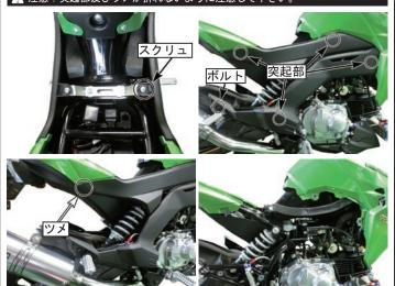
クイックリベットとスクリュ及びワッシャを取り外し、ミドルカウリングを外します。
