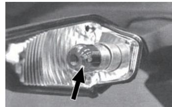
4. キット付属のハイパー LED ウィンカーバルブのピンをソケットの溝に合わせて押し込みながら、時計方向に回して取り付けます。
