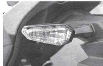
3. 電球を押し込みながら反時計方向に回し、取り外します。
