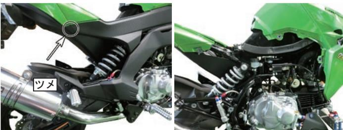
3. クイックリベットとスクリュ及びワッシャを取り外し、ミドルカウリングを外します。
