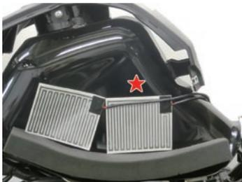
3. キット付属のスポンジ両面テープ 45x60 をハサミ等で幅 5mm 程度の短冊状に切断して片面のみ剥離紙を剥がし、適宜フューエルタンクにレジスターの配線を固定します。
