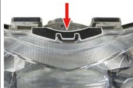
○本キット付属の①ヘッドライトユニットASSY. に装着されている、コネクタとラバーカバーを取り外し、ハロゲンバルブを取り外します。
