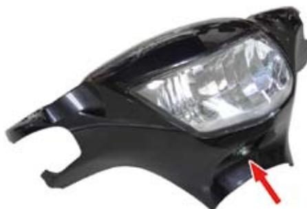
○純正ヘッドライトユニット上部のツメを、マイナスドライバー等で外して、ハンドルバーフロントカバーより純正ヘッドライトを取り外します。
