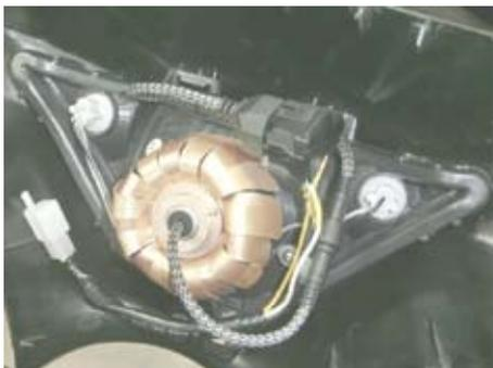
○車両のヘッドライトバルブコネクタに、キット付属の⑧ヘッドライトサブハーネスCOMP. を接続します。
