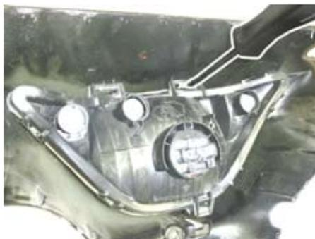
○純正ヘッドライトユニットの中央上部に貼り付けられているラバーを剥がし、キット付属のヘッドライトユニットASSY. に貼り付けます。
