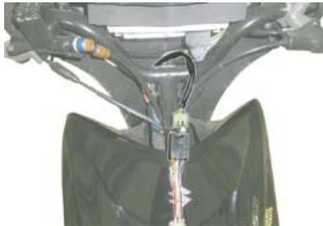
○①ヘッドライトユニットASSY. のポジションランプを点灯させる場合は、⑨インジケーターコード(レッド)を車体のオレンジ色配線に⑩エレクトロタップで接続し、⑨インジケーターコード(レッド)のメスギボシ端子と、⑧ヘッドライトサブハーネスCOMP. の赤色コード・オスギボシ端子を接続します。
