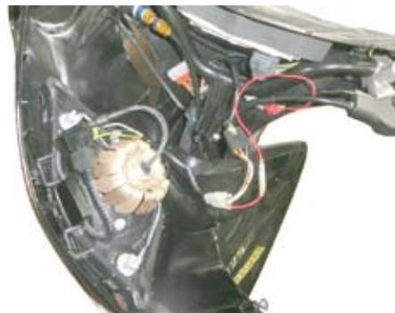
○配線類を挟まない様に注意し、フロントカバーを車両に仮付けします。この段階ではまだ仮付けで構いません。点灯確認を行った後、元通り組み付けます。
