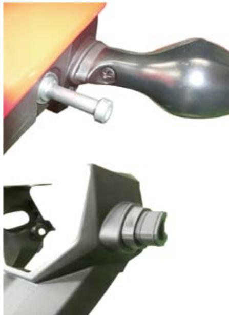
○ウインカーステーに①ストリームラインLEDウインカーを取り付けます。①ストリームラインLEDウインカー、⑤ウインカーカラー、④ウインカーマウント、車体側ウインカーステー部、⑩プレーンワッシャ 8mm (特寸)、③6角ナットの順で取り付けます。①ストリームラインLEDウインカーに⑤ウインカーカラーを取り付ける際は、カラーの品番が見えるように①ストリームラインLEDウインカーに通します。
