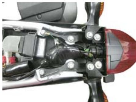
○ボルト4本とボタンヘッドスクリュー2本を外し、リアフェンダを取り外します。
