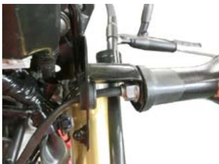
○車体側に①ストリームラインLEDウインカー、⑤ウインカーカラー、車体側メータステイ部、⑩プレーンワッシャ8mm(特寸)、③6角ナットの順で取り付けます。①ストリームラインLEDウインカーに⑤ウインカーカラーを取り付ける際は、カラーの品番が見えるように①ストリームラインLEDウインカーに通します。
