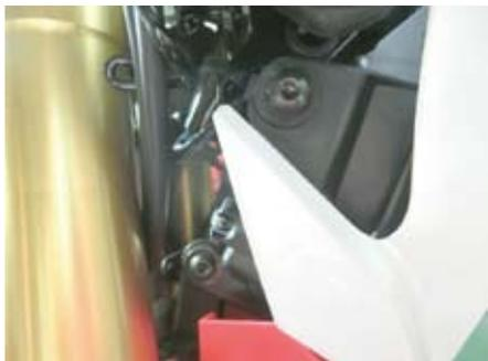
○フロントウインカーカブラを取り外し、ナットを外して、左右のノーマルウインカーをそれぞれ取り外します。
