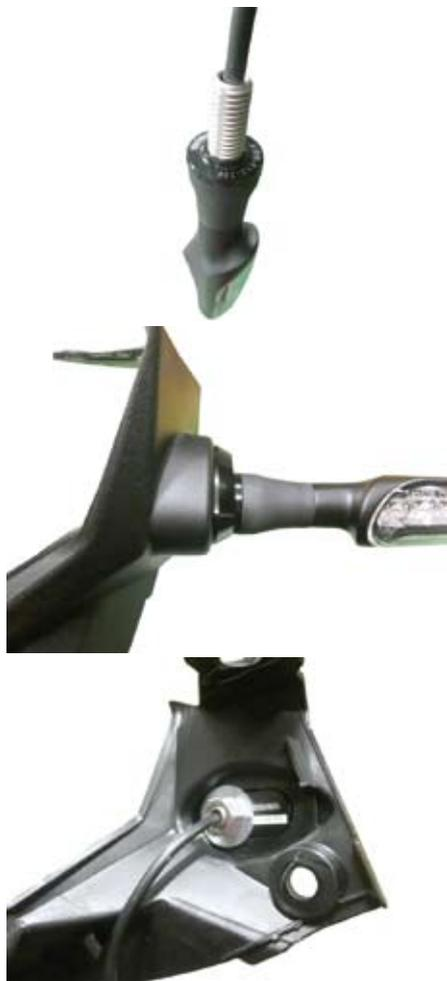
○ウインカーレンズが後ろ正面を向く様に、ウインカーの角度を調整し、6角ナットを締め付けます。
