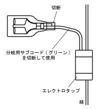
4. ウインカースイッチ部に接続したインジケーターノーマライザーのギボシ端子を、2本ともメーター裏に接続した分岐用サブコード(グリーン)のメスダブルギボシ端子に接続し、アッパハンドルバーカバーを元通りに組み付けます。
