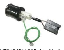
7. 車両にワイドレンジフラッシャーリレーを 取り付け、リレーコードの黒色カプラを車両 のウインカリレー接続コネクタに接続します。 アースコードの丸アース端子は、フロント カバー内のホーン取り付けスクリューと共締 めしますが、端子穴径が小さく取り付けしに くいため、キット付属の丸アース端子 6mm に 交換し共締めして下さい。
