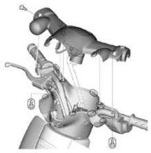
4. 純正ウインカリレーを取り外し、純正コネクタ 部のラバーカバーを取り外すか切除します。
