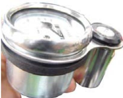
○取り外しの逆手順にて、スピードメーターを取り付け、コネクタを接続し配線類を③ヘッドライトケース COMP. 内に収めます。
