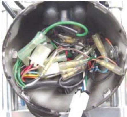
○③ヘッドライトケース COMP. 内の配線類を②ヘッドライトユニット COMP. が入りやすい様にセットし、ヘッドライトレンズの TOP マークを上向きにセットし、ヘッドライトソケットにコネクタを接続して②ヘッドライトユニット COMP. を④ケーススクリュー 2 本にて取り付けて下さい。
