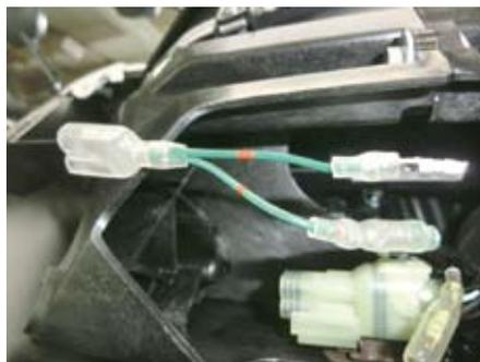
○① LED フォグランプにギボシをかしめていきます。予め① LED フォグランプの配線に⑥プラグキャップを通しておきます。赤コード、黒コード両方に⑤プラグをかしめます。
