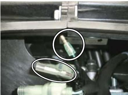
○商品に同梱している③④分岐用サブコードを車両側のギボシに接続していきます。取り扱い説明書の配線接続図を参照しながら、車両側黒赤コードに③分岐用サブコード(ブラック)を接続、車両側緑コードに④分岐用サブコード(グリーン)を接続します。
