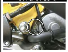
〇車体右側のリアブレーキスイッチの接続を 外し、ブーツに③サブハーネスを通します。
