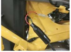
〇配線接続図と画像を参考にギボシを接続し、 配線をブーツの中に入れます。
