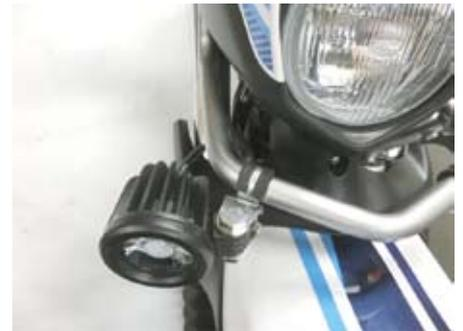
○配線接続図を確認しながら、① LED フォグランプ、②スイッチの配線接続をします。アースコードは車両左側のレクチャファイヤーと共締めして下さい。
