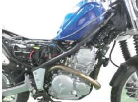
○③オプションハーネス COMP. をつけていきます。写真を参照し、車体側のスターターリレーに刺さっているカプラを抜き、③オプションハーネス COMP. を車体側スターターリレーと車体側メインハーネスの間に接続します。
