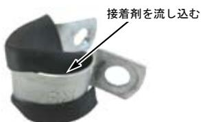
○⑦クランプステーとラバーが完全に接着された事が確認出来たら、ヘッドライトホルダーストッパーに取り付けます。
