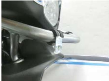
○① LED フォグランプからコの字ステーを取り外し、④ボタンヘッドソケットスクリュー、⑥カラー、コの字ステー、⑦クランプステー、⑤フランジナットの順に⑦クランプステーに取り付けます。
