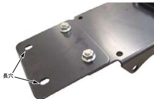
○フレーム→②フェンダーレスサブプレートの順に③フランジボルト、⑥フランジロックナットで仮締めする。
