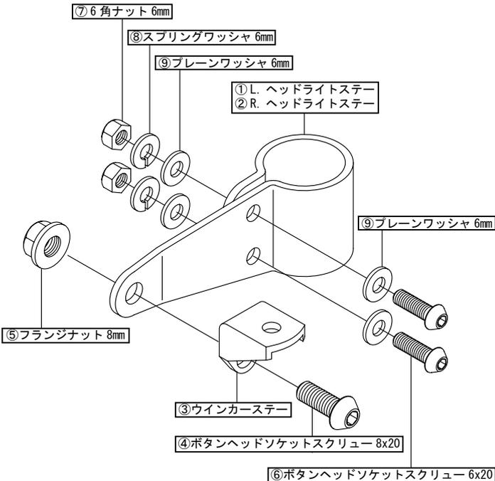
○L./R. ヘッドライトステーの間に、弊社製タイプCヘッドライトキットのケースを取り付け、④ボタンヘッドソケットスクリュー 8x20 をヘッドライトステー外側から通し、ヘッドライトケース内側に⑤フランジナット 8mm を取り付け、一旦仮付けします。
