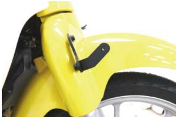
○③ロングステーに⑲フランジ 6 角ボルト 6x10 を用いて、① LED フォグランブを仮付けします。
