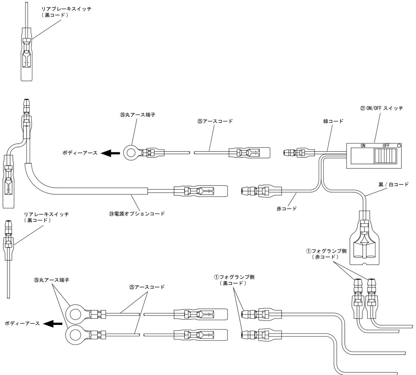
○配線接続図を参照し、ギボシ圧着加工を行って下さい。
