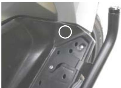
○配線を挟み込まない様に注意しながら、サービスマニュアルを参考に取り外した外装部品を逆手順で組み付けていきます。
