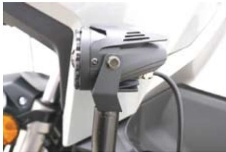
○点灯確認時に車両に跨り光軸が問題ないか確認し、必要に応じて位置を基準から調整して下さい。調整後は必ず規定トルクで再度締め付けて下さい。
