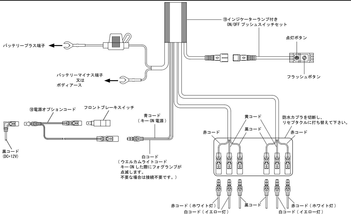
○配線接続図を参照し、ギボシ圧着加工を行って下さい。
