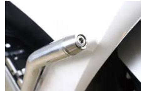
○②③ステー LR を取り付けした①LED フォグランプをフロアステップサイドバーの先端に取り付け、キャップでステーを挟み込み、ボルトで仮留めします。
