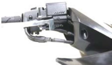
○③インジケータランプ付き ON/OFF プッシュスイッチを操作しやすい箇所に⑤両面テープを使用し貼り付け、コードは①LED フォグランプが接続しやすいように下の方に持ってきておきます。
