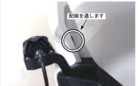
○取扱説明書の配線接続図を参照しながら、配線を接続します。必要に応じて、⑨結束バンドをご使用下さい。接続が完了したら、バッテリーのマイナス端子を接続し、一度①LED フォグランプを点灯させ問題ないか確認し、③インジケータランプ付き ON/OFF プッシュスイッチの動作確認も行って下さい。
