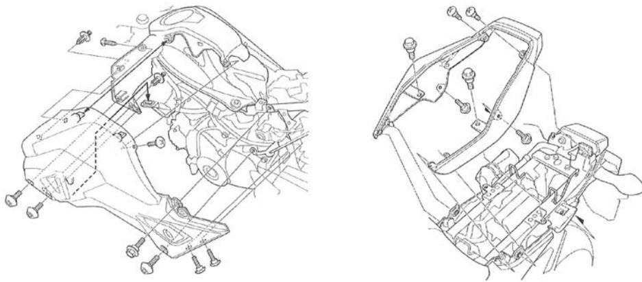
●モンキー 125に取り付けの場合は純正サービスマニュアルを参照し、マフラー、シート、サイドカバー及びバッテリーのマイナス端子を取り外します。
