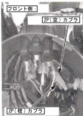
○ウインカー取り付け部のキャップナットを取り外し、左右のフロントウインカーをそれぞれ取り外します。
