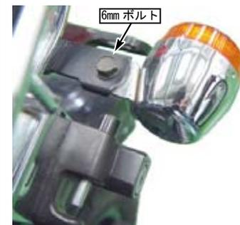
○フロントと同様に①ストリームラインミニ LED ウインカーのコードを⑥ウインカーブラケット、②プレーンワッシャ 8mm、④6角ナットの順に通してウインカー ASSY. を仮止めします。
