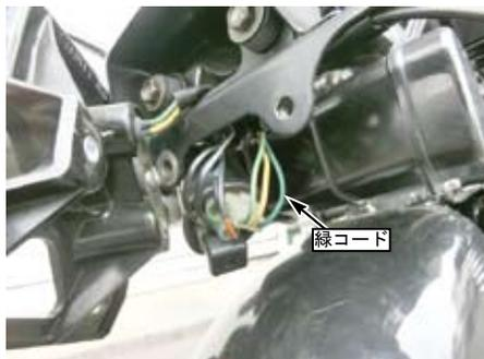
○ウインカー及びテールランプの配線を束ね、コネクターカバーを被せ、カバー中央部をクランプにて固定します。
