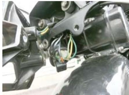
○ウインカー取り付け部の6mm ボルトを取り外し、左右のリアウインカーをそれぞれ取り外します。
