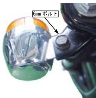
○①ストリームラインミニ LED ウインカーのコードを⑥ウインカーブラケット、②プレーンワッシャ 8mm、④6角ナットの順に通してウインカー ASSY. を仮止めします。
