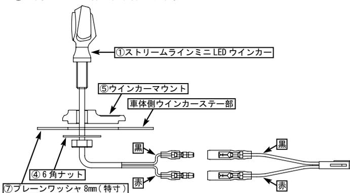
○ウインカーレンズが正面を向く様に、ウインカーの角度を調整し、④6角ナットを締め付けます。
