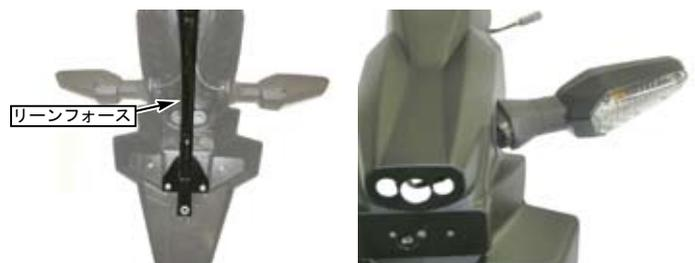
○①ストリームラインミニLEDウインカーの端子を⑩プラグ（オスギボシ）に打ち換えます。
