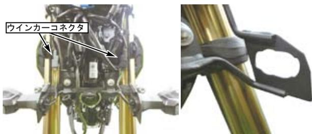
○①ストリームラインミニLEDウインカーの端子を⑩プラグ（オスギボシ）に打ち換えます。
