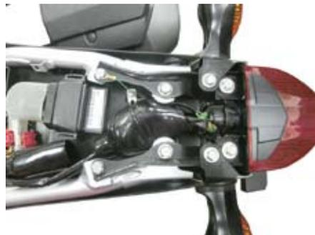
○ボルト4本とボタンヘッドスクリュ2本を外し、リアフェンダを取り外します。
