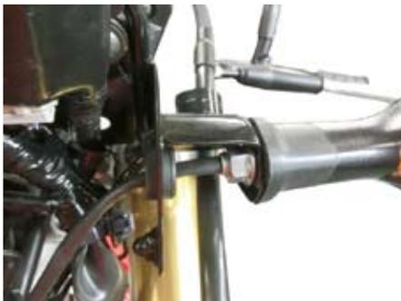
○①ストリームラインミニLEDウインカーに電ペンチを使用し⑭プラグ(オスギボシ)を圧着します。
