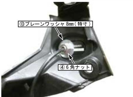
○ウインカーレンズが後ろ正面を向く様に、ウインカーの角度を調整し、④6角ナットを締め付けます。
