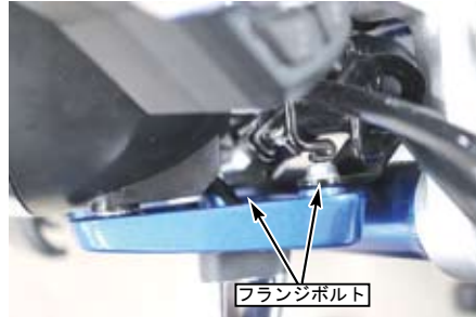
弊社製ヘッドライトステーの場合 ・ソケットキャップスクリュー 6x25 (00-00-0722) が必要になります。
